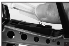
1. 将摄像头扣在起落架的接口上。
