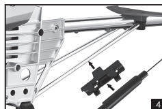
4. 将天线套扣在飞机的斜管上，然后把摄像头天线安装在天线套上。
