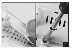
1. 将摄像头扣在主体下的接口上，再将螺丝按顺时针旋转拧紧。
