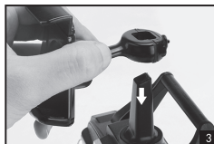
3. 将手机固定架套在遥控器上。
