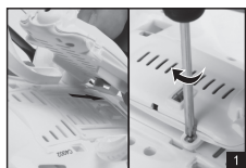
1. 将摄像头扣在主体下的接口上，再将螺丝按顺时针旋转扭紧。
