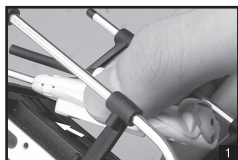
1. 将摄像头扣在起落架的接口上。
