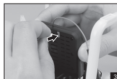
3. 将摄像头连接线的白色接口跟摄像头上的接口连接。
